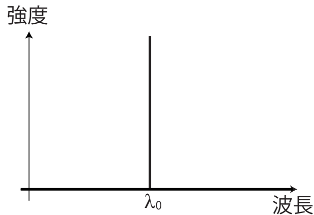
図 1: 気体分子 1 個が放射する輝線スペクトル
